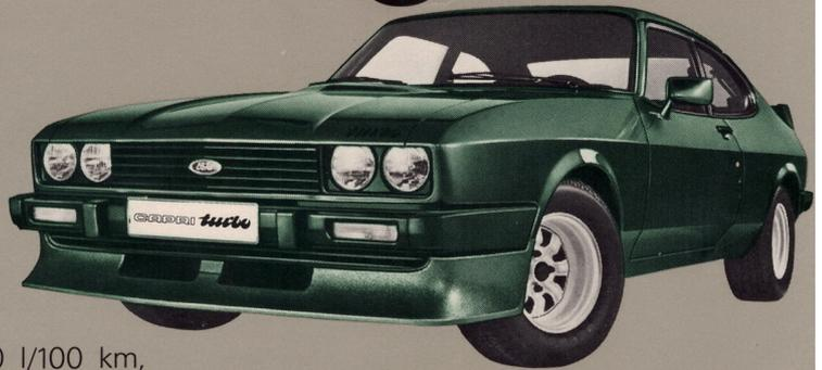
**Geballte Kraft.** 2,8-Liter, V6-Motor (Vergaser), 188 PS bei 5500 U/min., Turbolader, kontaktlose Transistorzündung.
